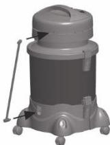
7. Kontroller, at slangen, der forbinder basen med motorhuset, er fastgjort til dens pladser på motorhuset og bundhuset ved at trykke på den.
