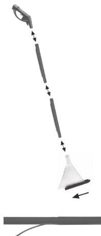
2. Για τον καθαρισμό των υαλοπινάκων, οδηγήστε το ακροφύσιο πλυσίματος χαλιών της συσκευής σας προς τα αριστερά περνώντας το μέσα από τα καρφιά του ακροφυσίου γυαλιού και σκληρού δαπέδου με το ρυθμισμένο μέρος προς τα δεξιά..
