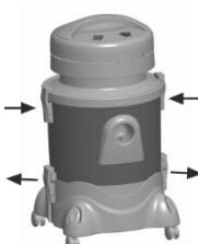
3. Τοποθετήστε το μεσαίο σώμα της δεξαμενής στη δεξαμενή όπως φαίνεται στο σχήμα.
