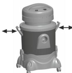
5. Setzen Sie das Motorgehäuse wieder auf den Tank, indem Sie es vom Tragegriff halten, und verriegeln Sie die Riegel, indem Sie es nach rechts und links drücken.
