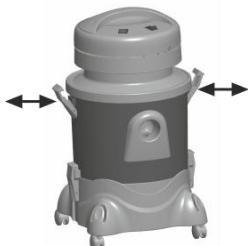
1. Entriegeln Sie die Schlossriegel, indem Sie sie wie in der Abbildung gezeigt herausziehen, und entfernen Sie dann den Motorkörper, indem Sie ihn am Tragegriff festhalten.
