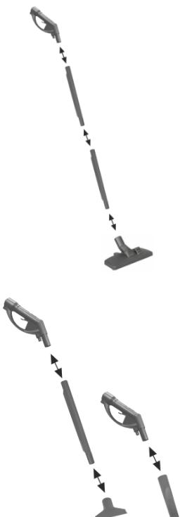
Τοποθετήστε τους σωλήνες επέκτασης στη λαβή του εύκαμπτου σωλήνα και μετά στον σωλήνα επέκτασης του κατάλληλου ακροφυσίου που θα επιλέξετε ανάλογα με την επιφάνεια που θέλετε να καθαρίσετε.
